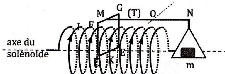
Si  $I' = 0$ , la tige (T) et les côtés (DE) et (FG) sont horizontaux ; l'axe du solénoïde est parallèle à (T), dans le même plan vertical et le milieu K du côté (FG) est au centre du solénoïde. Le côté (FG) du cadre est à l'extérieur.
