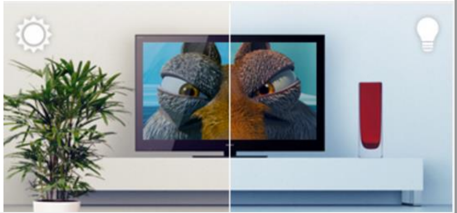
Figure -2- Capteur de lumière ambiante Image à gauche: température des couleurs normales. Image à droite: température des couleurs qui tend vers le bleu. Source: sony.fr
